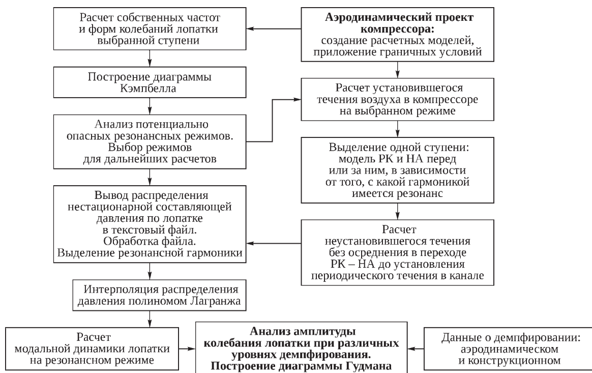
Рис. 3. Структурная схема процесса вычисления амплитуды переменных напряжений в лопатке компрессора при возбуждении резонансных колебаний по собственной форме гармоникой, обусловленной числом впереди (или сзади) стоящих лопаток НА
